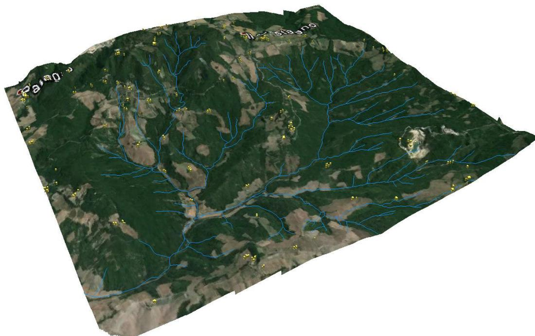
Figura 13 – Modello 3D con sovrapposizione dell'immagine aerea tratta da Google Earth, estrusione aree urbanizzate, sovrapposizione scorrimento superficiale del torrente Capriggine.
