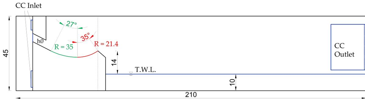
Figura 5.2: Geometria della simulazione 1 → Sezione piano [X Z].
